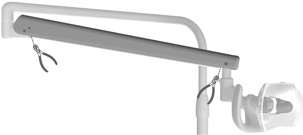
A-dec 361 型支撑中心上的 A-dec 371 型安装式示意图
