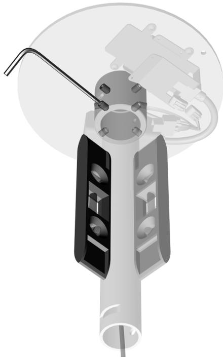
**1** 用一組調平螺釘將水平儀垂直放置在支柱上。
