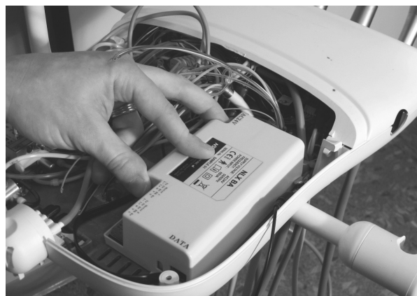
図 11. コントロールヘッドへのコントロールモジュールの配置
