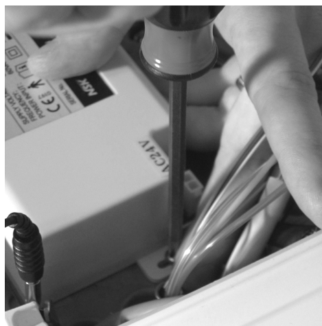
図 26. コントロールモジュールのマウント
