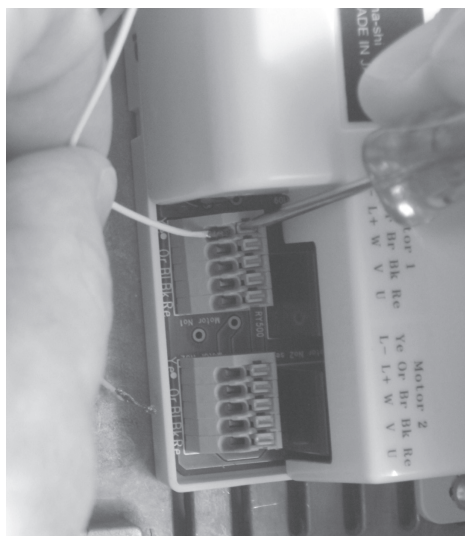
図 14. ハンドピースモーターワイヤーの接続
