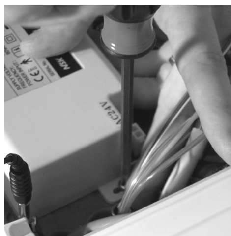
図 12. コントロールモジュールのマウント
