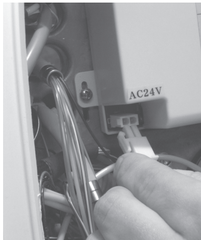
図 13. AC電源のプラグイン
