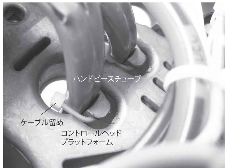
図4. Traditionalシステムへのチューブの取り付け
