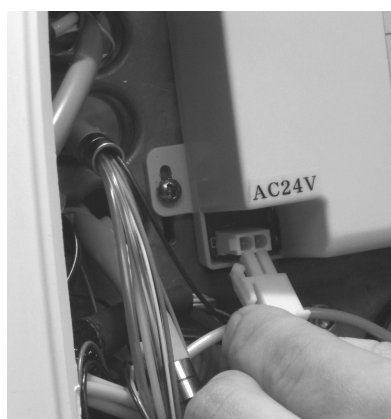
図 27. AC電源のプラグイン
