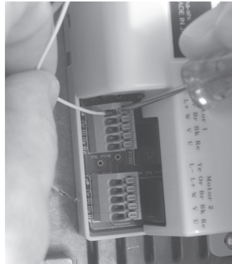
図 28. ハンドピースモーターワイヤーの接続
