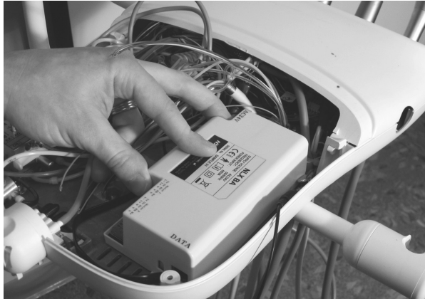
الشكل 11. ضبط وضع وحدة التحكم على رأس التحكم
