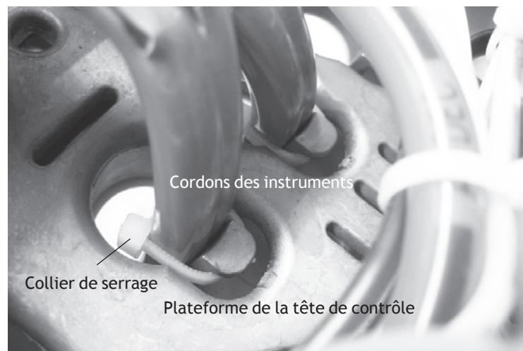
Figure 3. Installation du cordon dans un système Traditional
