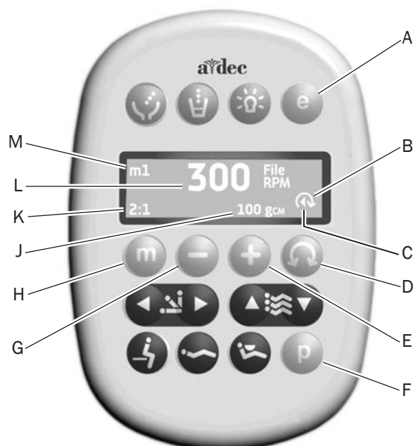
Рисунок 4. Экран сенсорной панели в режиме эндодонтии
