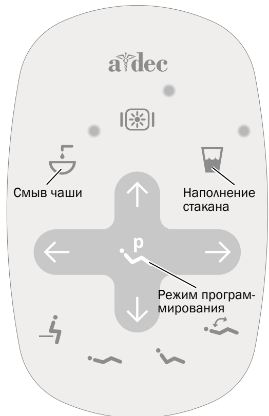
Показана типовая сенсорная панель управления
