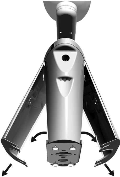
2. Schieben Sie das Lager bis zum Anschlag in die Säule der Zusatzkonsole ein.
