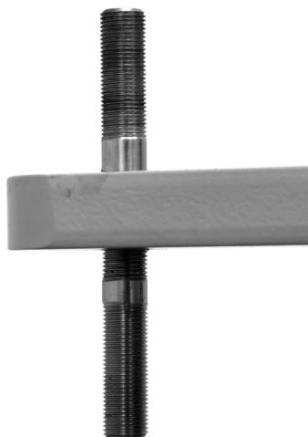
Переднее крепление кресла Decade, подготовленное к установке
