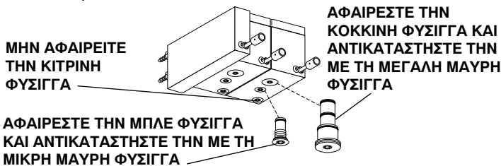
Εικόνα 11. Μετατροπή Ξηρού Κιβωτίου Χειρολαβής
