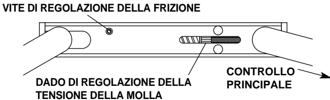
Figura 18. Ubicazione dei dispositivi di regolazione della tensione
