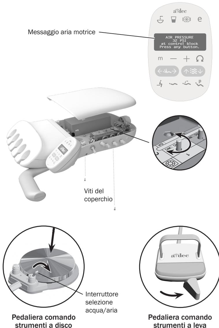
È possibile controllare la pressione dell'aria motrice sul touchpad deluxe premendo contemporaneamente  $-$  e  $+$ . Per i riuniti con un touchpad standard e per una misurazione più accurata dell'aria motrice, utilizzare un manometro (codice articolo A-dec 50.0271.00) montato sul cordone del manipolo.
