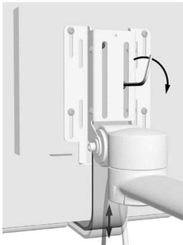
3. Чтобы расположить держатель ближе к монитору, сдвиньте кронштейн ниже на держатель. С помощью шестигранного ключа 5/32 дюйма сдвиньте верхний винт на более низкую позицию на держателе.
