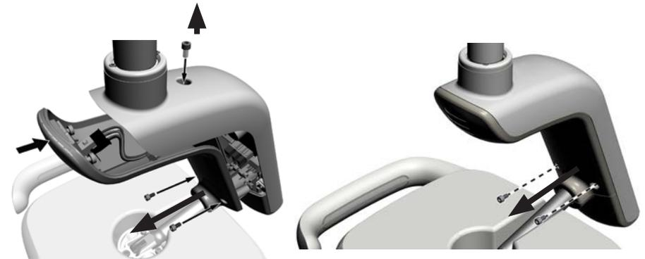
2. Возьмитесь за корпус привода и большими пальцами рук вытяните крышку корпуса привода из корпуса.
