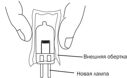
6. Снимите наружную обертку и утилизируйте ее, затем установите на место экран светильника.
