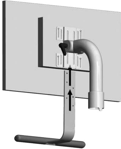
4. С помощью шестигранного ключа 5/32 дюйма зафиксируйте держатель на консоли VESA.
