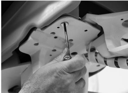
3. Sur la face inférieure du cadre du fauteuil, utiliser une clé 3/4 po pour desserrer le contre-écrou au bout de la vis de réglage de la tension.
